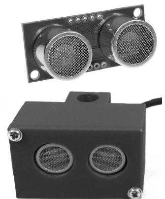
Hình 2: Cảm biến siêu âm SRF 05 và hộp cảm biến hoàn thiện
